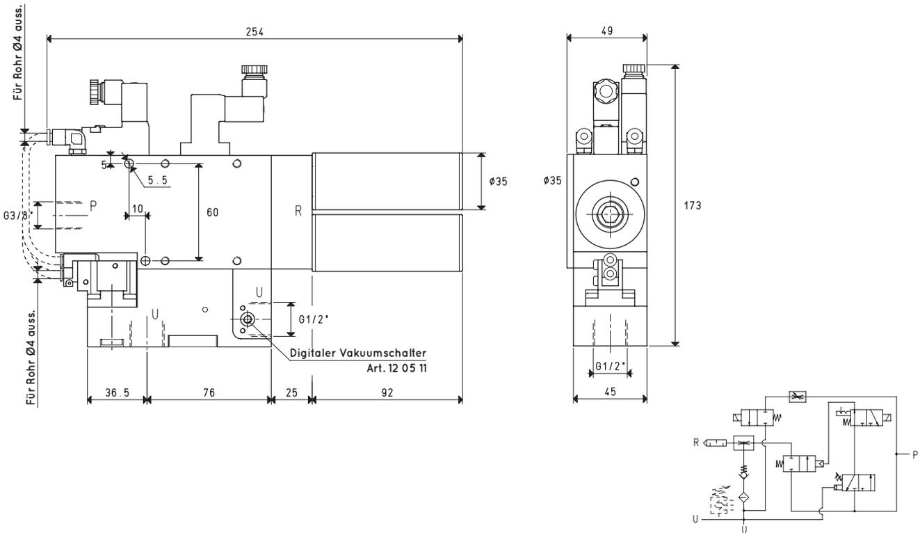
P=DRUCKLUFTANSCHLUSS      R=AUSLASS      U=VAKUUMANSCHLUSS
